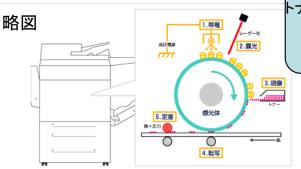
トナーを紙に熱で定着させているため、 インクジェット用紙の使用は 絶対に止めてください!
