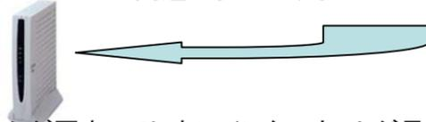
このモデムが固まってしまうインターネットが見えなくなります。対処法は、モデムの電源を抜き差しするだけで復旧します。(HUBがある場合も同様に抜き差し実施) 上記のように、電源を入れなおすと復旧することが多いのがOA機器、コンセントが抜けている事なんてことも実は結構トラブルの原因で多いんですよ。(注意!! パソコンは電源抜き差しではなく必ず再起動です!)
